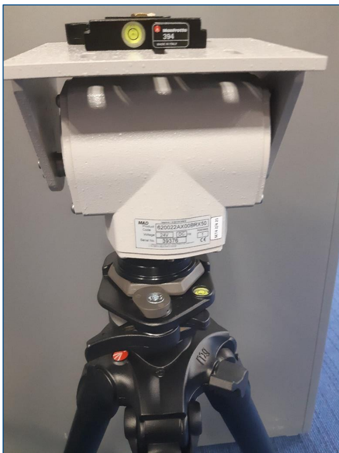
Figuur 5 Pan/tilt bevestigd op statief
