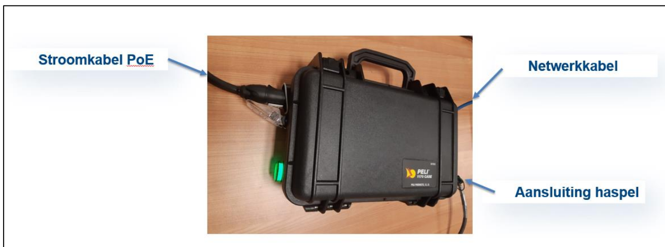
Figuur 11 Aansluitingen Camera-voeding
